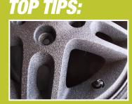
DO NOT COAT THE BACK SIDE MOUNTING SURFACE WHERE THE WHEEL AND HUB MAKE CONTACT.
